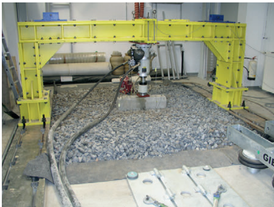
Abb. 8: Dauerbelastungsversuch mit dynamischer Lasteintragung am Großversuchsstand der Hochschule für Technik und Wirtschaft Dresden (FH)
